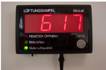
Die Lüftungsampel hat eine gut sichtbare Anzeige der aktuellen Konzentration an CO<sub>2</sub> in ppm (parts per million) als Zahlenwert und informiert zusätzlich über Signallämpchen selbsterklärend über die Notwendigkeit des Lüftens, ähnlich einer Verkehrsampel. Grünes Licht bedeutet "Gute Luft", Gelb zeigt an, dass eine verstärkte Lüftung wünschenswert wäre und rotes Licht signalisiert die sofortige Notwendigkeit einer verstärkten
