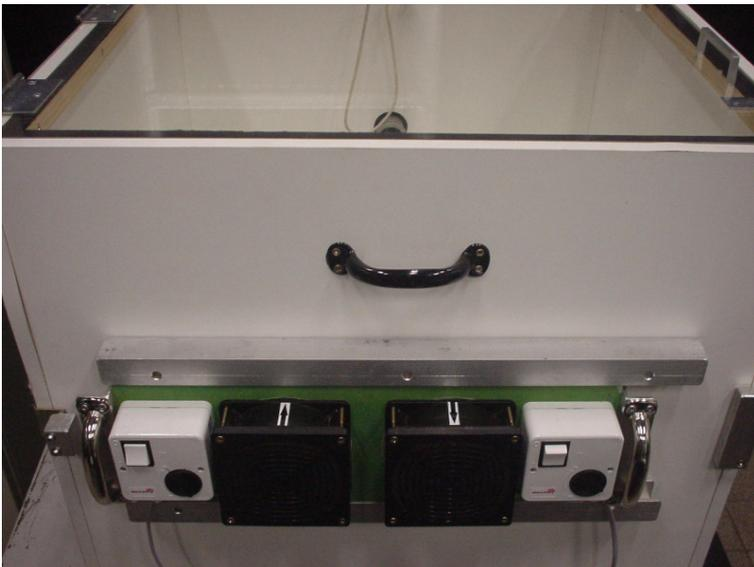
Abb. 13: Ansicht der Ventilatoren an dem Probennahmegerät, die einen Über- oder Unterdruck in dem Gehäuse erzeugen können
