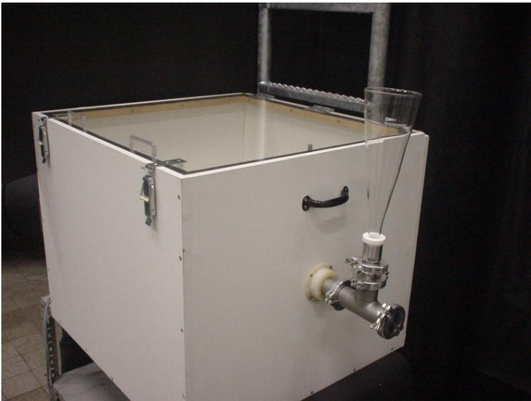
Abb. 12: Probenentnahme- und Probendarbietungsgerät AirProbe I
