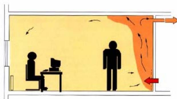
Abbildung 6.12: Kurzschluss bei Quelllüftung im Heizfall (REHVA Guidebook Nr. 1)
