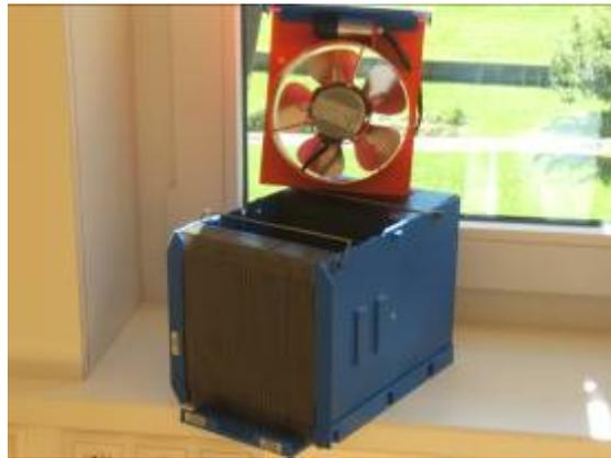
Abbildung 9.62: Lüftungsgerät in seine Bestandteile zerlegt
