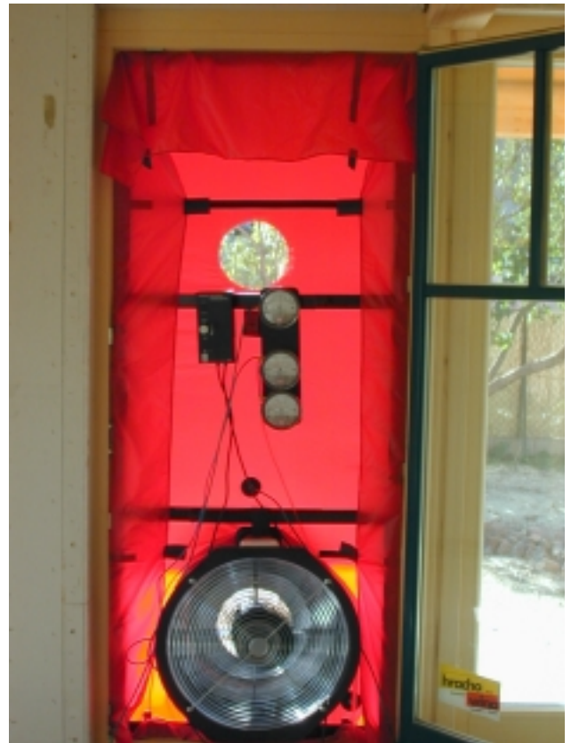
Blower-Door Apparatur im Türrahmen
