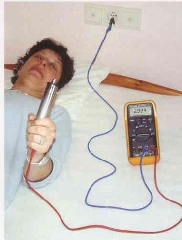
**Bild 1: Körperspannungsmessung gegen Erdpotential mittels Digitalmultimeter**
